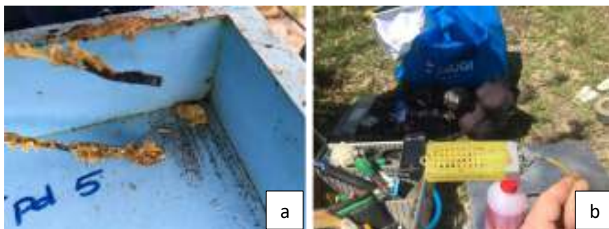
Figura 7. a) sensori interni dell'arnia ricoperti di cera; b) posizionamento del sensore all'interno di una gabbietta per regina
