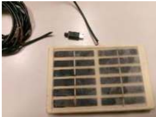
Figura 9. Pannello solare con cavo rotto durante la gestione dell'arnia
