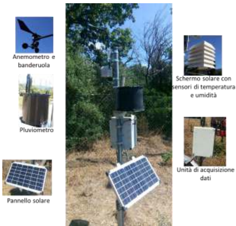
Figura 8. Principali sensori presenti in una stazione meteorologica completa
